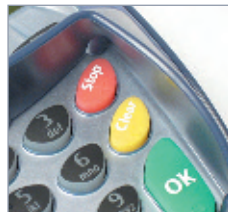
Tastatur mit ergonomischem Sichtschutz und taktilem Symbolen
